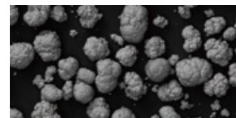
FLASH pearl (炭酸カルシウム) 平均粒子径 54μm SEM画像(x150)
