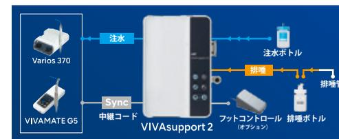
パリオス370との接続にはオプションのVS分岐チューブが必要です。シンクロモード以外でもコントロールパネルの注水ON/OFFキーを押すことで注水が可能です。
