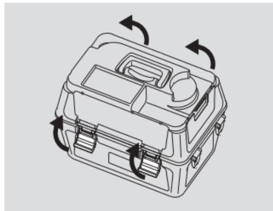
**7** コントロールユニットにトップケースを正しくセットし、バックル（4箇所）をロックします。
