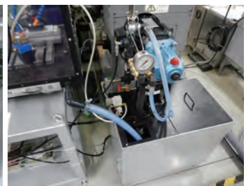
水循環機タンク（100ℓ）
