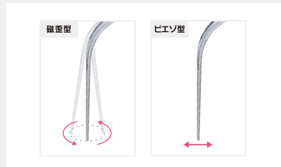
図1: 磁歪型とピエゾ型の振動方向の違い。
