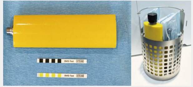
図2: ハンドピース内部への蒸気浸透を模したテストデバイス
