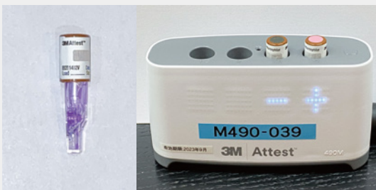
図6: 生物学的インジケータ アンプルの中に耐熱性の高い指標菌Geobacillus stearothermophilusが植菌されており、滅菌後に培養して死滅しているか否かを検証する。
