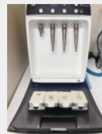
図8: 自動注油器iCareを使用したハンドピースへの注油
