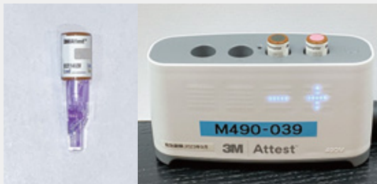
図6: 生物学的インジケータ アンプルの中に耐熱性の高い指標菌Geobacillus stearothermophilusが植菌されており、滅菌後に培養して死滅しているかを検証する。
