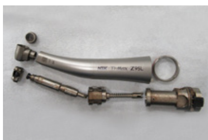
図1: ハンドピース内部の汚染 不十分な洗浄後に滅菌を繰り返すと、付着した唾液や組織片等の汚染物が滅菌時の熱で内部にこびりついてしまう。
