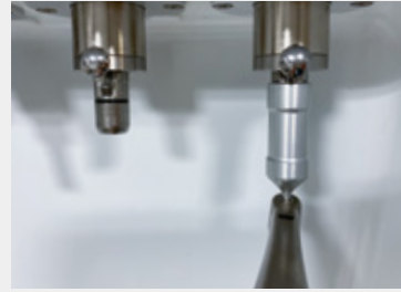
図6: チャック部分への注油 ジョイント"4"に「チャック清掃用ノズル」を装着し、ハンドピースのパール取り付け穴をノズルチャック清掃用ノズルの先端に合わせ、手で把持・固定し、スタートさせる。
