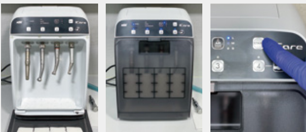
図5: 自動注油機iCareの使用法
