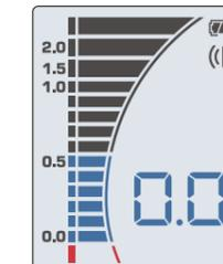
ファイル先端が根尖孔に達するとバーグラフは「0.0」を表示、アラート音が連続した音に変わります。
