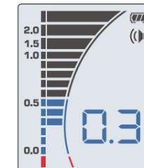
ファイル先端が根尖部付近に達するとバーグラフの色が青色に変わり、同時にアラート音も変化します。バーグラフとアラート音との変化により根尖孔に近づいている事をお知らせします。
